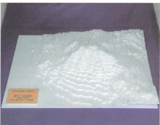
図 12 完成した積層型の筑波山模型。寸法 30cm × 21cm, 縮尺約 1/25000, 鉛直方向の強調倍率は 1.5 倍。
