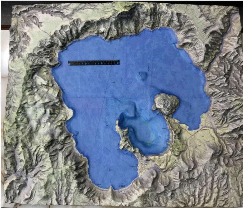
十和田湖周辺の模型（上：南西から北東方向への俯瞰、下：南から北への俯瞰） 模型寸法は 700mm×600mm、縮尺 1/20,000、Z 軸方向に 1.5 倍強調。
